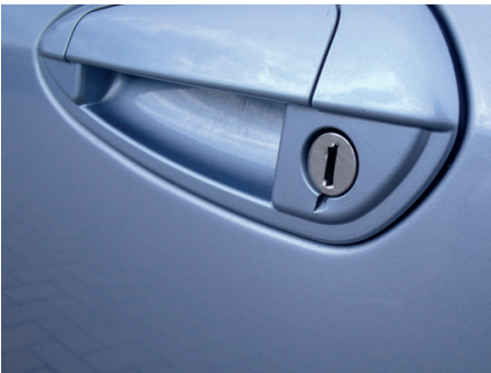
Schade door inbraak .
